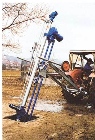
Насос установленный на тракторе, в комплекте с лифтом и лебедкой
