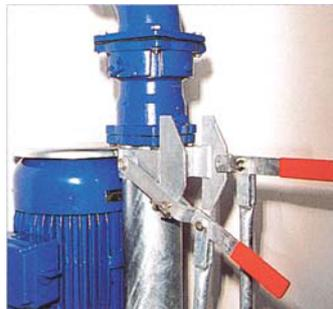
Рычажные рукоятки для управления откачиванием и перемешиванием
